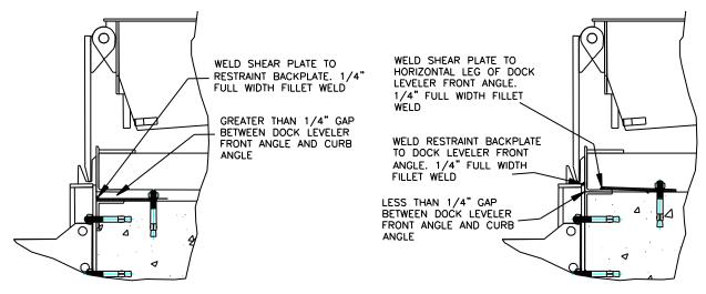
IF THE HEIGHT OF THE RESTRAINT BACKPLATE IS EQUAL OR GREATER THAN THE FRONT CURB ANGLE
