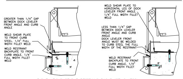
IF THE HEIGHT OF THE RESTRAINT BACKPLATE IS LESS THAN THE FRONT CURB ANGLE
